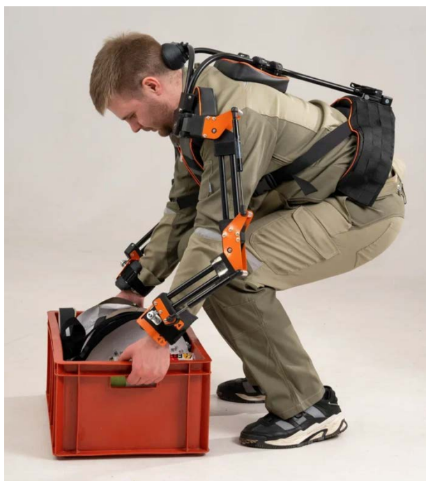
Рисунок 6 – Принцип работы с грузом в экзоскелете
