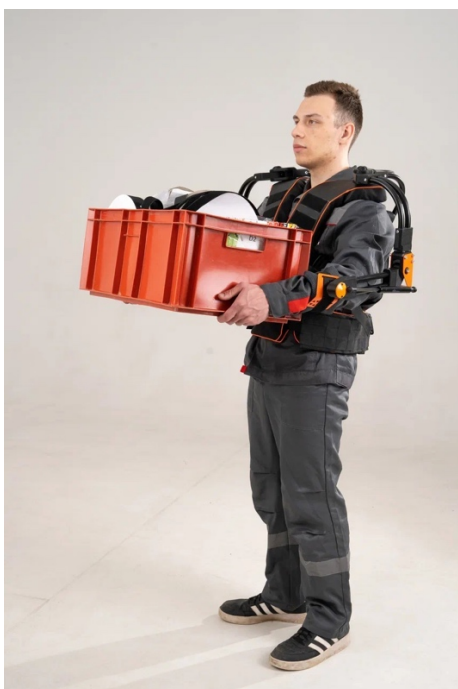
Рисунок 6 – Принцип работы с грузом в экзоскелете
