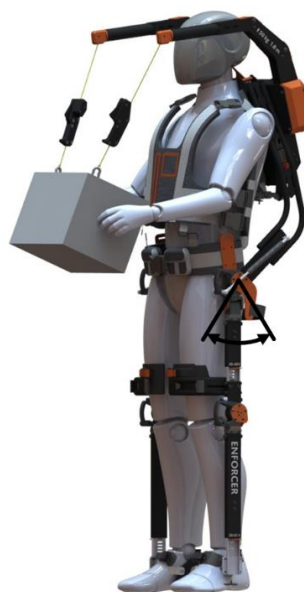
Рисунок 3 – Диапазон вращения бедренного шарнира при ходьбе
