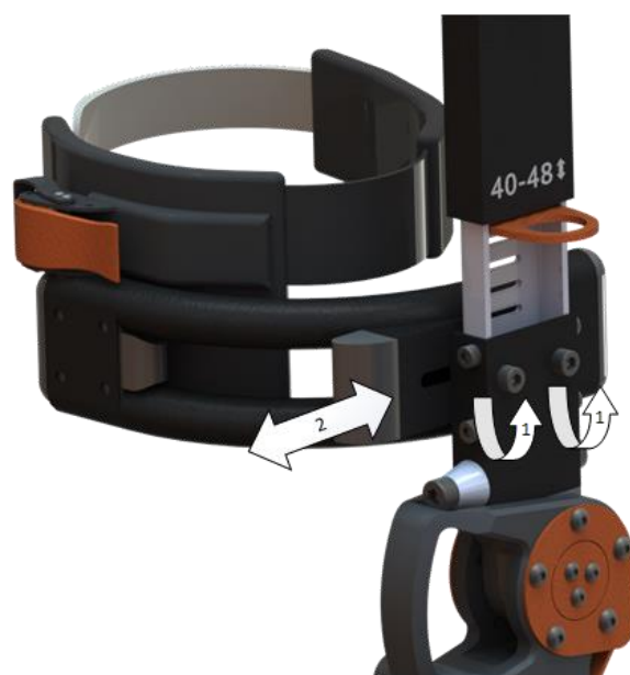
Рисунок 10 – Схема регулировки вылета бедренной манжеты
