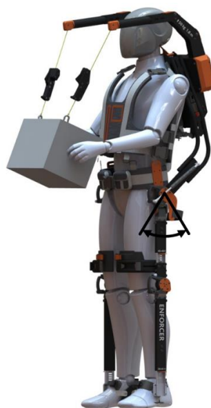
Рисунок 3 – Диапазон вращения бедренного шарнира при ходьбе
