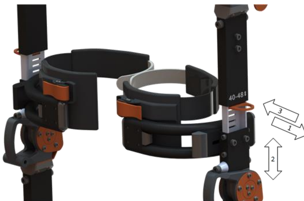
Рисунок 9 – Регулировка длины звена бедра
